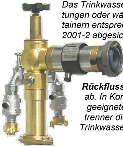
Das Trinkwassernetz muss z.B. bei Festveranstaltungen oder während der Versorgung von Baucontainern entsprechend der EN 1717 und der DIN 2001-2 abgesichert werden. Der Systemtrenner BA für Standrohre ist dafür die richtige Lösung. Er reagiert bereits bei einer Druckdifferenz von 0,14 bar und sichert gegen
